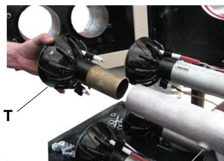
17 вынуть голову сгорания: для чистки головы сгорания необходимо удалить загрязнения ручным пылесосом методом всасывания, если имеются жесткие отложения - удалить их с помощью металлической щетки;
