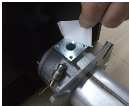
2) повернуть Горелка и Снять заглушку;
