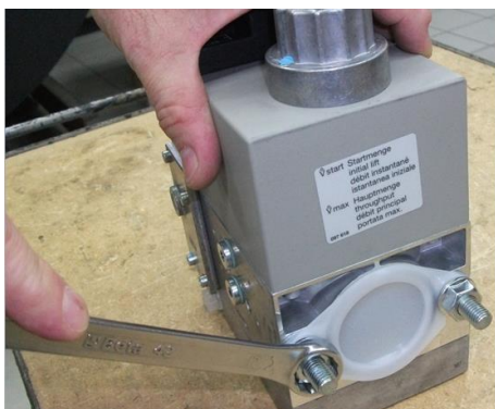
7) Снять заглушку из электроклапан;
