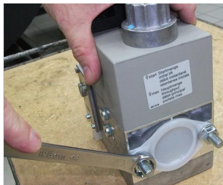
8) Снять заглушку из электроклапан;
