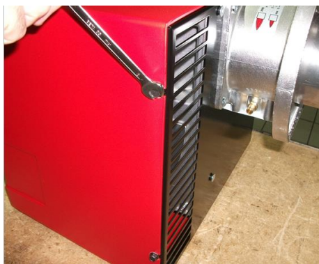
1) Снять кожух, ослабив 4 винта;
