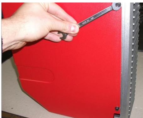
10) Снять кожух, ослабив 4 винта;
