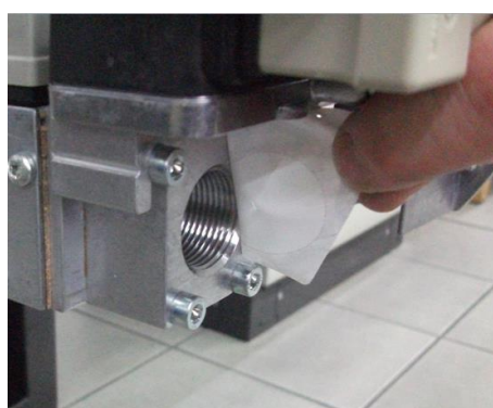
8) Снять заглушку из Труба ГАЗОВОЙ ramпы;
