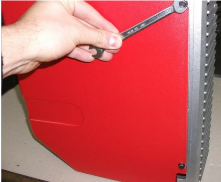
1) Снять кожух, ослабив 4 винта;
