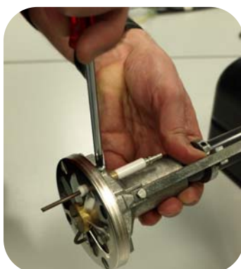
6- Вывинтить крепежный винт электрода обнаружения пламени и демонтировать сам электрод.
