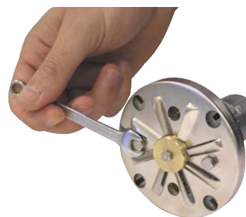
4- Снять провод зажигания и ионизации.
