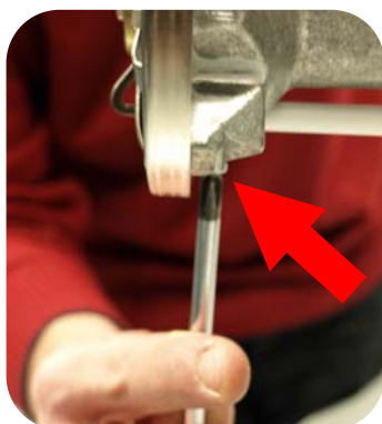
5- Вывинтить крепежный винт электрода розжига.
