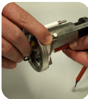
7- Установить заново провод зажигания и ионизации.
