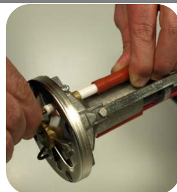
4- Снять провод зажигания и ионизации.
