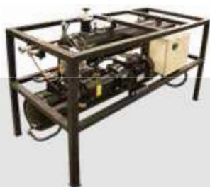
Насосная станция предва- рительного подогрева
