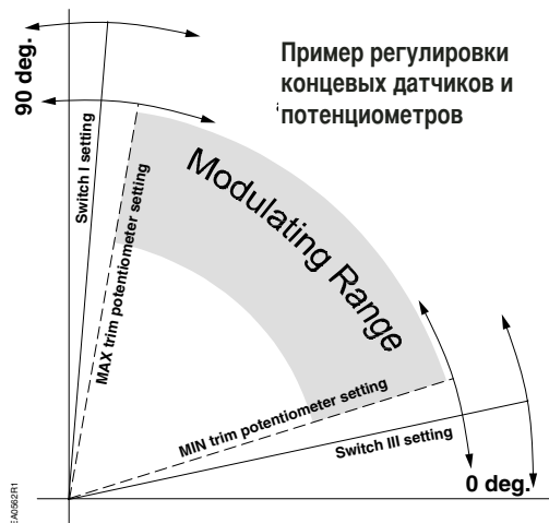
Рис. 13. Установка кулачков и подстроечных потенциометров.
