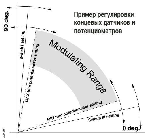
Рис. 13. Установка кулачков и подстроечных потенциометров.
