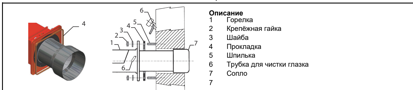
Рис. 5 Монтаж горелки на котле
